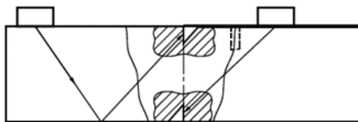
Рисунок 8 - Настройка диапазона развертки по угловым отражателям
